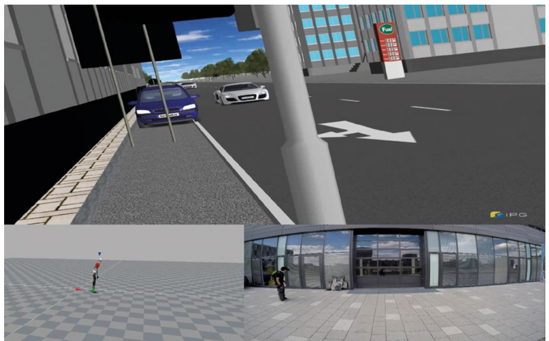
Oben: Visuelle Rückkopplung zum Probanden. Unten links: Xsens Motion Capture System. Unten rechts: Proband bei einer virtuellen Straßenüberquerung. © THI
