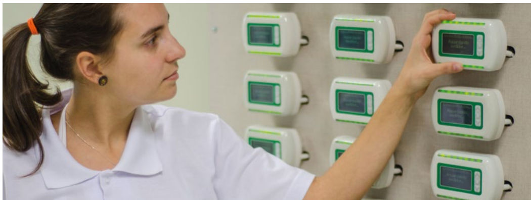
Sensorsystem zur Stromnetzüberwachung, entwickelt von den Lactec-Instituten in Kooperation mit dem Technologieunternehmen (Coelba-Energieberatungsprojekt). © Lactec-Institute
