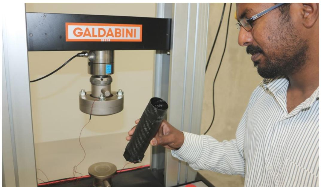
Gerald Siqueira an der Universalprüfmaschine für die Untersuchung von faserverstärkten Leichtbaumaterialien. © THI
