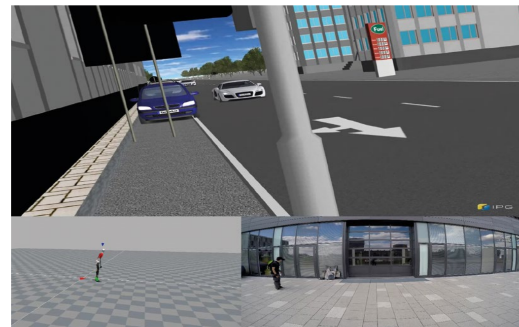
Painel superior: Sujeito no simulador virtual de tráfego. Painel inferior esquerda: Sistema de captura de movimentos. Painel inferior direito: Sujeito em um cruzamento em uma estrada virtual. © THI
